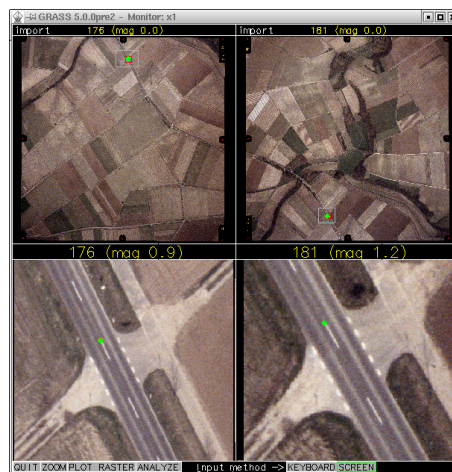
Abbildung 11.1.: Nutzung von i.points zur Identifizierung von Passpunkten in Luftbildern
