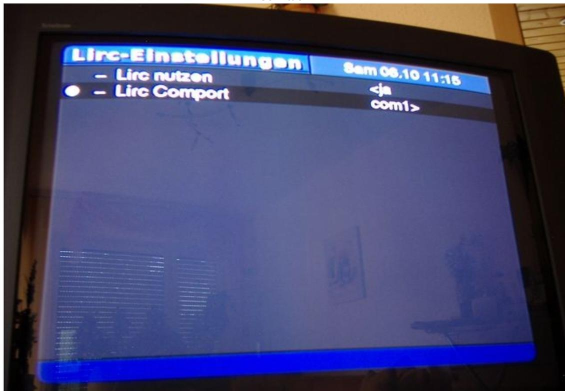
In dem Menüpunkt „- Lirc Comport“ müssen sie nun die Einstellung von „<com1\_both>“ auf „com1>“ ändern. Dazu nehmen Sie die Cursor-Tasten (Pfeiltasten) links und rechts. Bei der richtigen Einstellung drücken Sie bitte die Eingabetaste. Verlassen Sie nun bitte das Menü durch drücken der Taste „M“ und starten Sie den Digitainer neu, indem Sie ihn durch kurzen druck auf den Netzschalter runterfahren und anschliessend neu starten. Wir haben fertig! :-)
