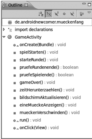
Abbildung 5.13 Die »Outline«-View von Eclipse stellt alle Elemente einer Klasse in einer Baumstruktur dar.
